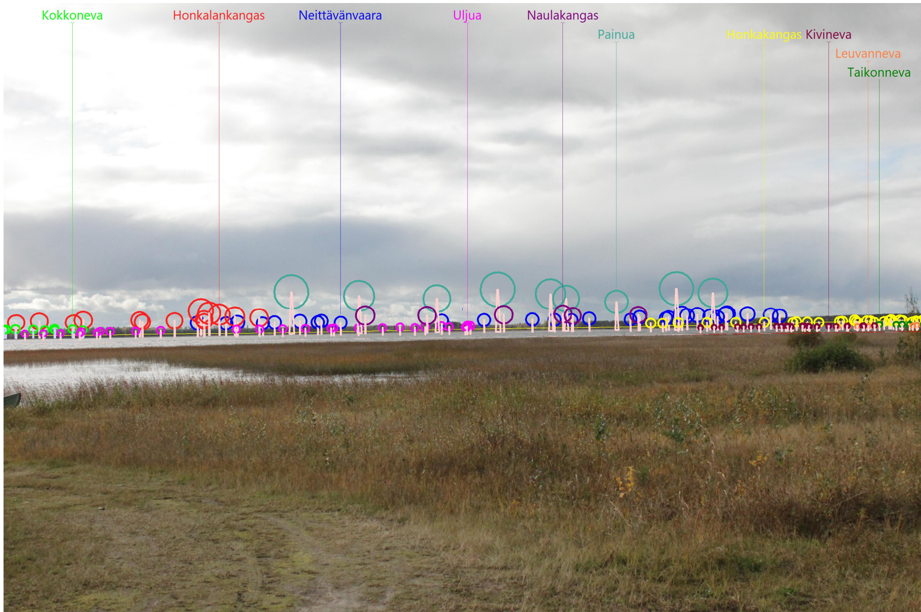
Tuulivoimaloiden sijoittumisen rautalankamalli, pyörähdysala ja numerointi.
