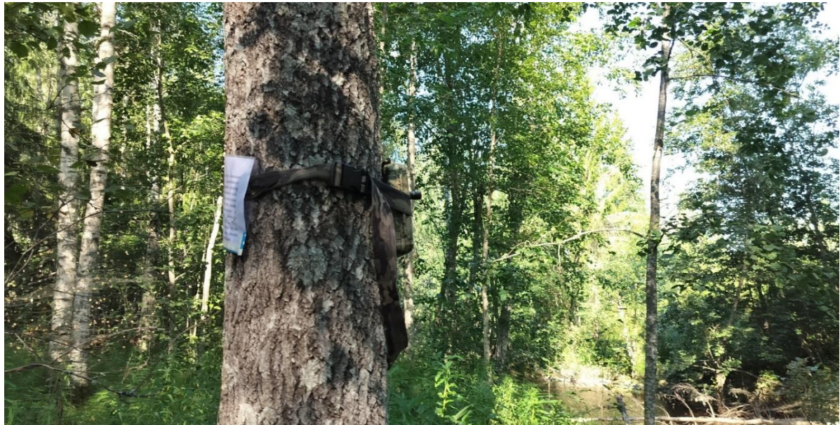
Kuva 63. Anabat Express passiividetektori valmiina tallentamaan lepakoiden ääniä.
