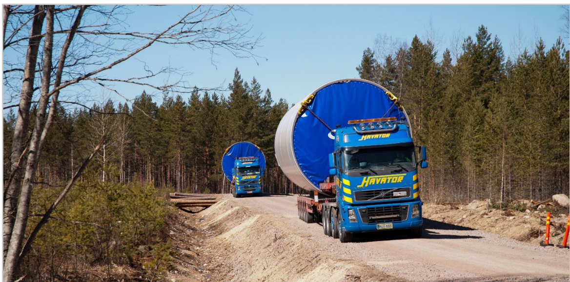
Kuva 44. Esimerkkikuva tuulivoimalan tornin osien kuljetuksesta hankealueella ja valmiista huoltotiestä. (Taaleri Energia Oy)
