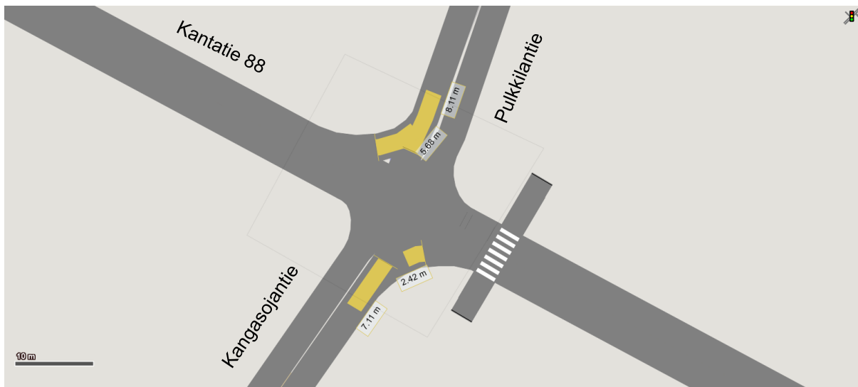
Kuva 25: Liittymän maksimijonopituudet huipputunnin aikana.
